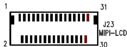
**注意：J23 MIPI 屏接口和 J29 LVDS 接口内部复用一个 MIPI 通道，如需使用 J23 则请调整硬件拆除 U9026 芯片、加焊 8R60,8R61,8R68,8R67,8R66,8R65,8R64,8R19,8R70,8R69 共 10 个 0R-0402 电阻。**
