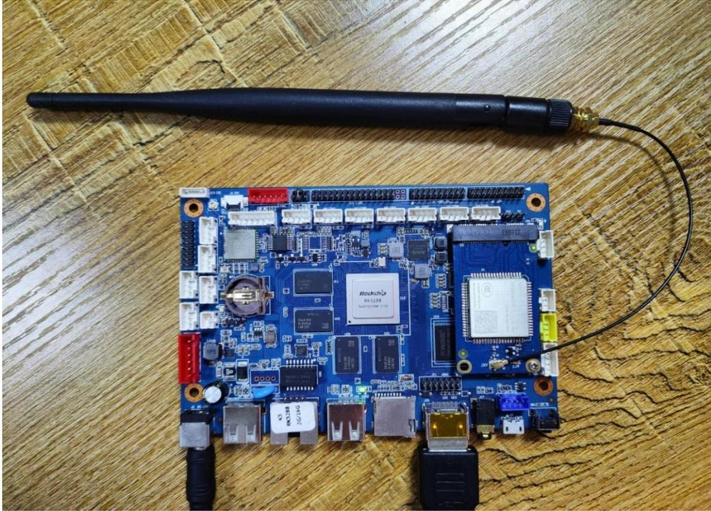
b.主板不带 PCIE 接口，模块接到 E1 小板，通过 J1 USB 接口与安卓主板的 USB 接口连接，如 E1 小板的 J1 接口与 M3 主板的内置 USB 连接
