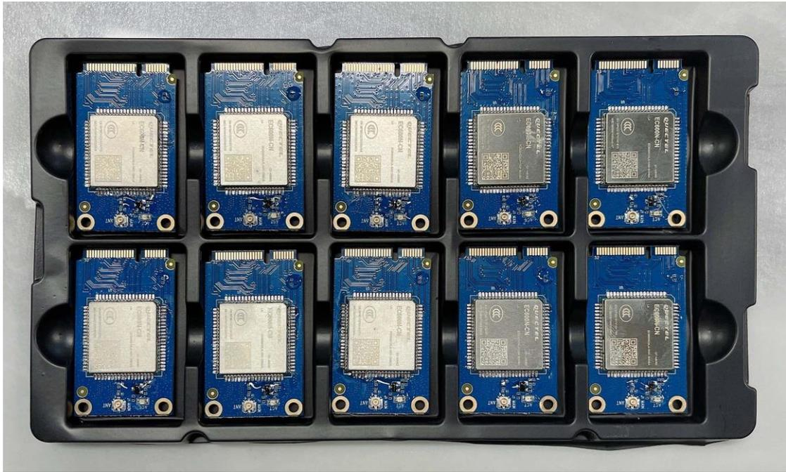
模块结构尺寸为 30mm\*50.7mm\*3.3mm，固定孔直径大小 3.0mm。
